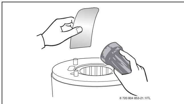
Afb. 71 Controleer het verwarmingslichaam op restanten
