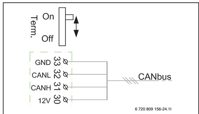
Fig. 10 Terminaison CAN-BUS
