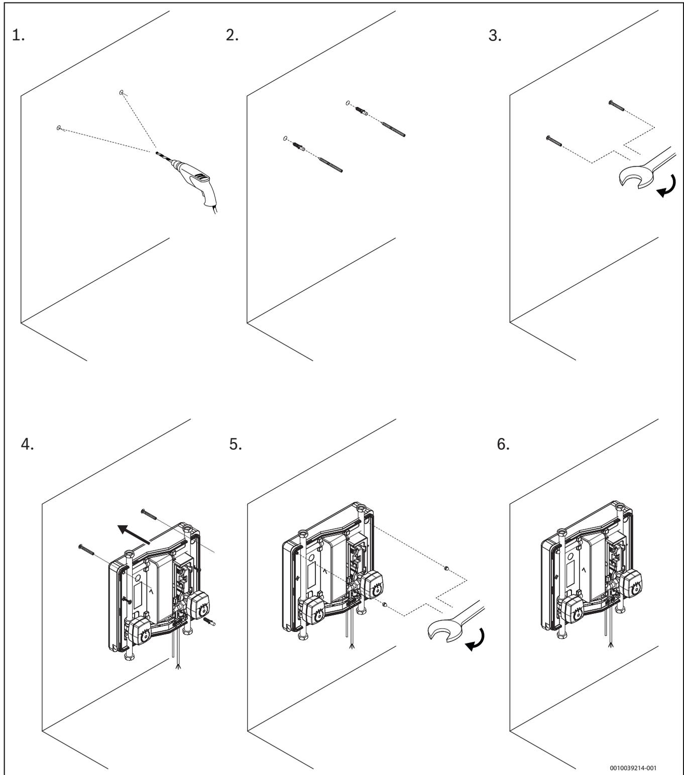
Fig. 7 Installation au mur de la station de refroidissement
