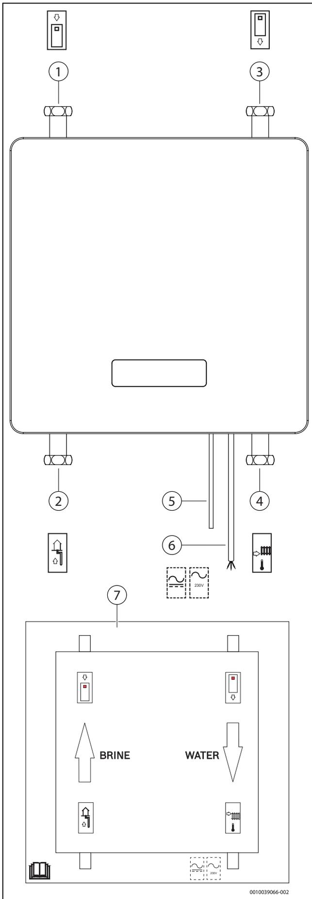
Fig. 4 Raccords sur la station de refroidissement passive
